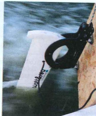
A haute vitesse, même avec un cordage à faible allongement, la tension sur celui-ci fait que l'appareil a tendance à basculer.
