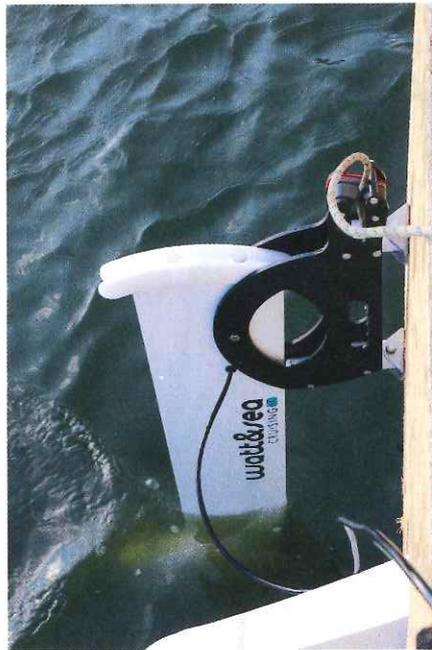
Les hélices des modèles Save Marine, Watt&Sea et SWI-TEC sont fixées sur un support profilé, avec un casque permettant de relever l'appareil, mais seul le support Watt&Sea est monté comme un safran dont il a d'ailleurs la forme.
