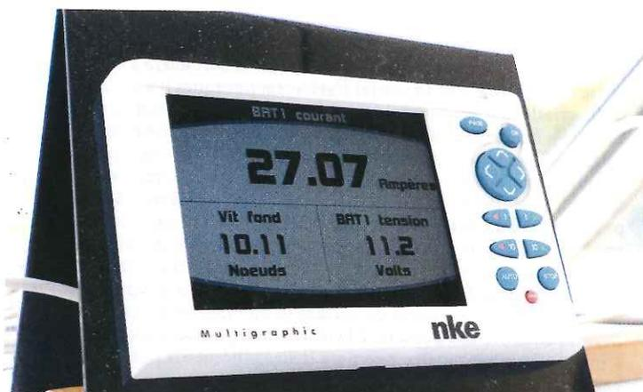
Un afficheur Multigraphic, un contrôleur de batterie et un GPS haute fréquence (le tout fourni par NKE) nous ont permis d'avoir sous les yeux les données essentielles: vitesse, intensité de charge et tension de la batterie.
