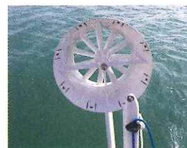
L'alternateur n'est pas dans l'axe de l'hélice... et le stator est dans le carénage.
